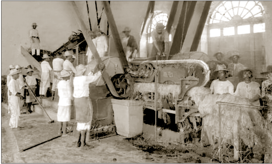
Pedro Guerra, Fototeca Pedro Guerra, Fondo Pedro Guerra. La descripción de la fotografía menciona que se trata de una máquina desfibradora de la hacienda Sacapuuc.
